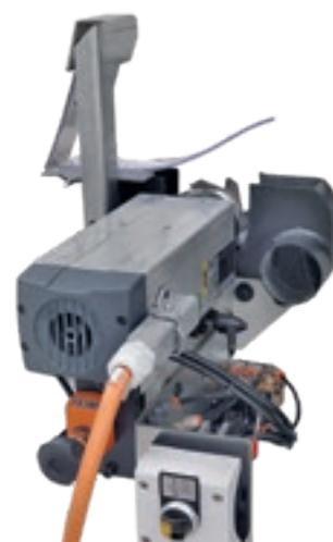
O Grupo Fresador permite realizar a fenda e a fresagem na superfície inferior do painel.
