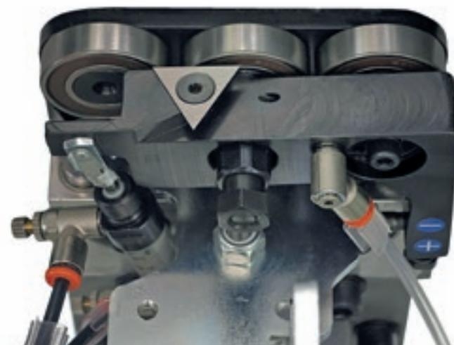
O Grupo raspador de cola que remove os excessos de cola na parte superior e inferior do painel.
